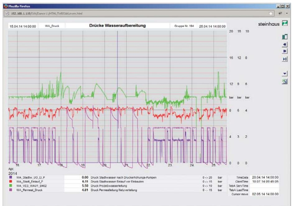
Abb. 2 Detaillierte Daten aus der Wasseraufbereitung: Speziell nachteilige manuelle Eingriffe können sauber zugeordnet werden
