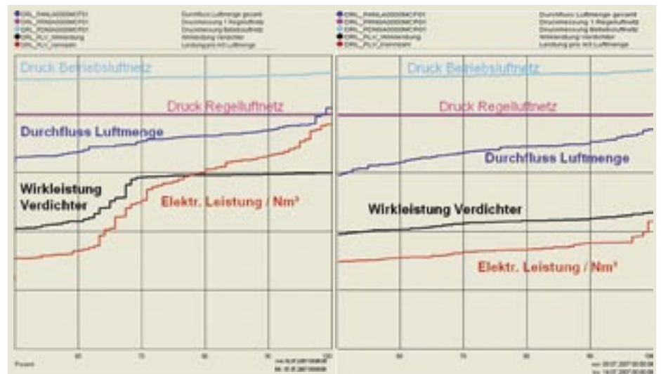
Abb. 3 Druckluftherzeugung – Verteilungsfunktion vor/nach Einführung der Kennzahl
